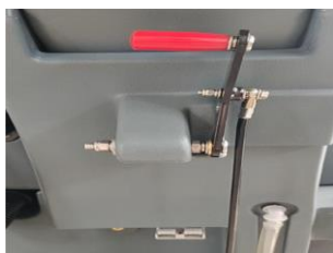
(Рис. 3) Зарядный порт и ручка опускания водосборного скребка
